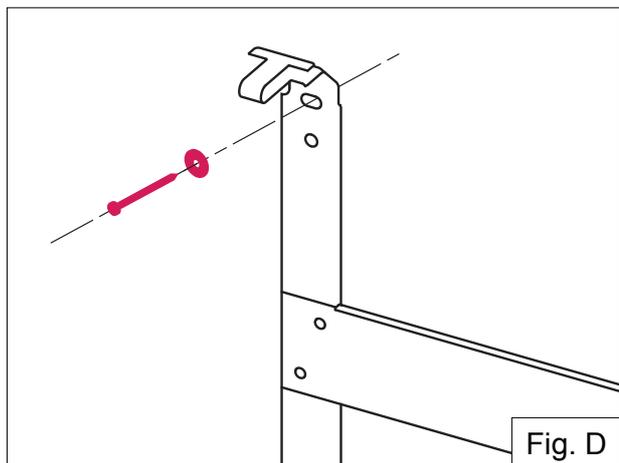
Fixer le dossieret (support mural) aux 4 endroits prévus à cet effet, en prenant soin de monter les rondelles en acier zingué fournies avec votre appareil conformément au schéma ci-contre.
