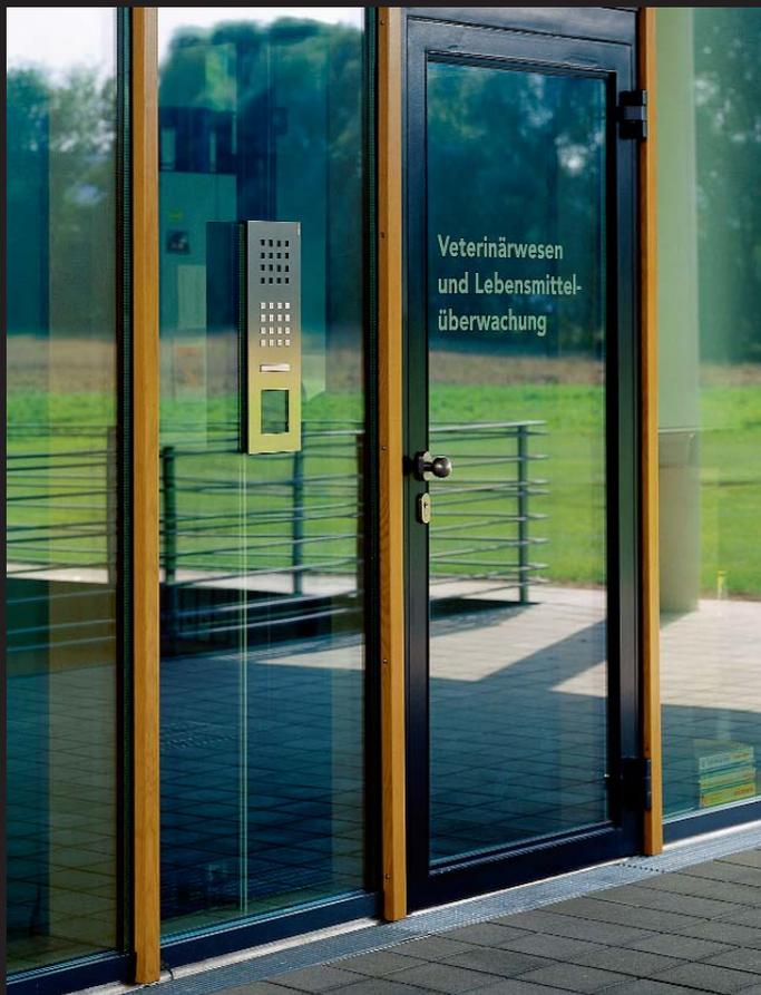
Siedle-Steel für den Glaseinbau wird ohne Rahmen oder zusätzliche Befestigungen direkt im Glas angebracht. Beim Direkteinbau in einen Glasausschnitt ist die Verkabelung Teil des Designkonzepts. Sie wird durch eine flexible Edelstahlmantelung nach unten geführt. Die Anlage „schwebt“ in ergonomisch korrekter Höhe.
